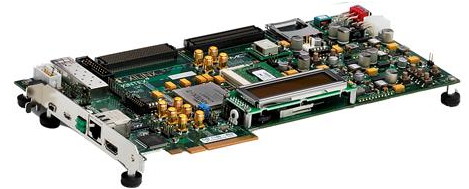
開発した 33 コア・アーキテクチャを実装した FPGA ボード
